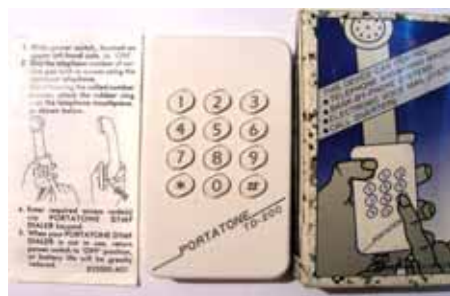
11 Генератор тона для подачи тонового сигнала по телефону, не обеспечивающему перехода в тоновый режим (частная коллекция)
