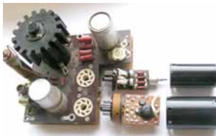
9 Транзисторные каскады, оформленные как электронные лампы (частная коллекция)
